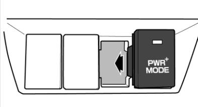
1. スイッチを取り付け後に配線をスロットルブースター本体端の3極カプラーに接続して下さい。
